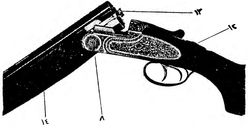
جفت « بماسورتين » فوق بعضها في حالة الفتح ( لاحظ النازع رقم ١٣ )
